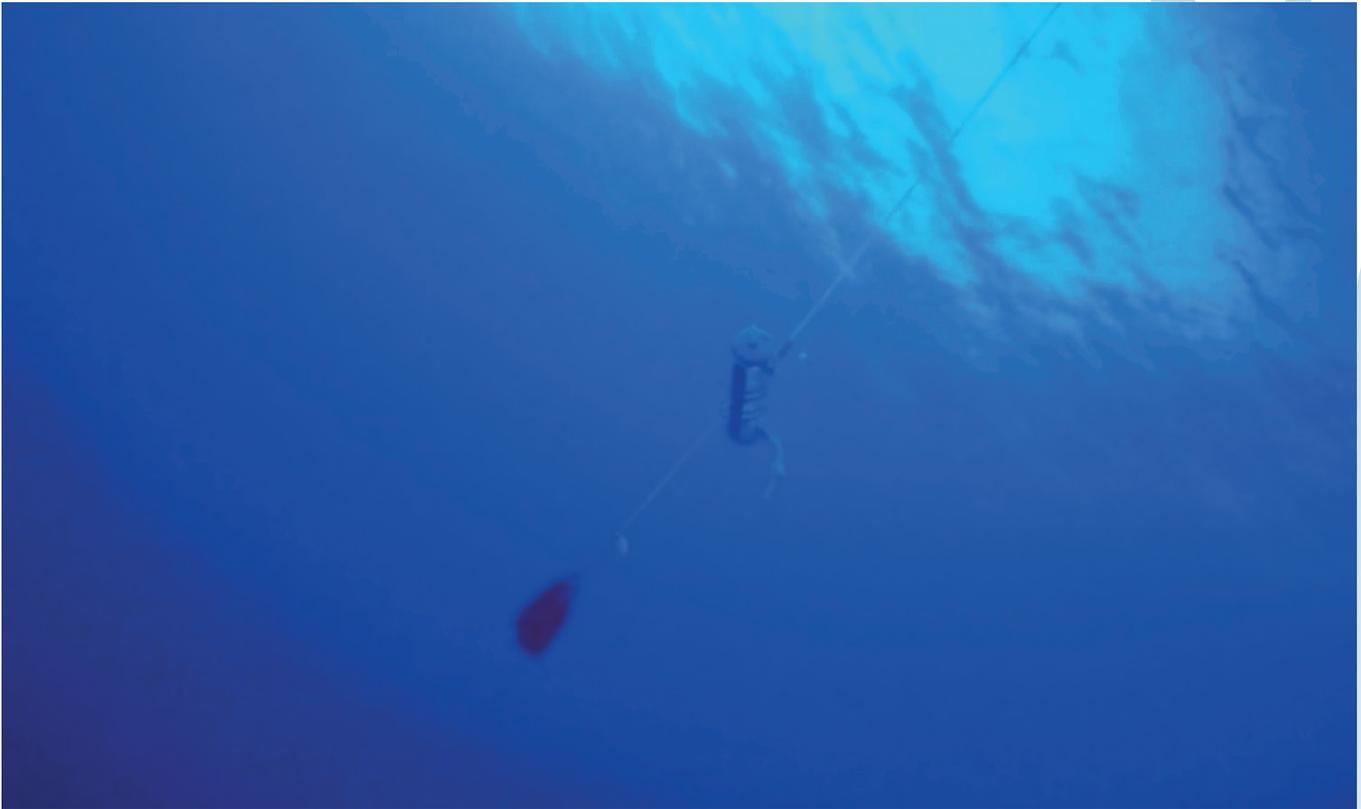
Botella tipo Van Dorn sumergida en aguas de la isla de Cozumel, utilizada para coleccionar muestras de agua para posteriores estudios del fitoplancton. Fotografía: Ernesto Hevia.
